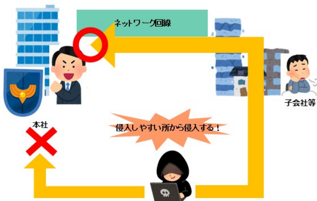
図 I-2 : サプライチェーン攻撃の説明図。本社のサイバーセキュリティ対策が万全だったとしても、子会社のサイバーセキュリティ対策が万全でなければ、ネットワークを通して子会社からサイバー攻撃を受ける。
